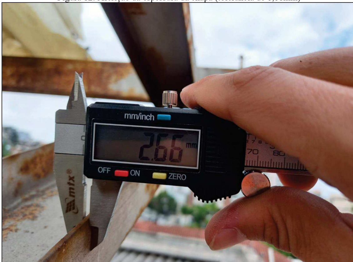
Figura 12: Aferição da espessura da chapa (tolerância de 0,01mm)
